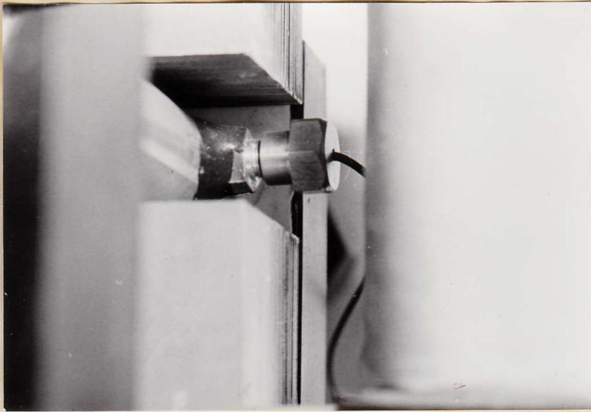
Bild 10 : Stopfbuchse zur Elektrodenführung
